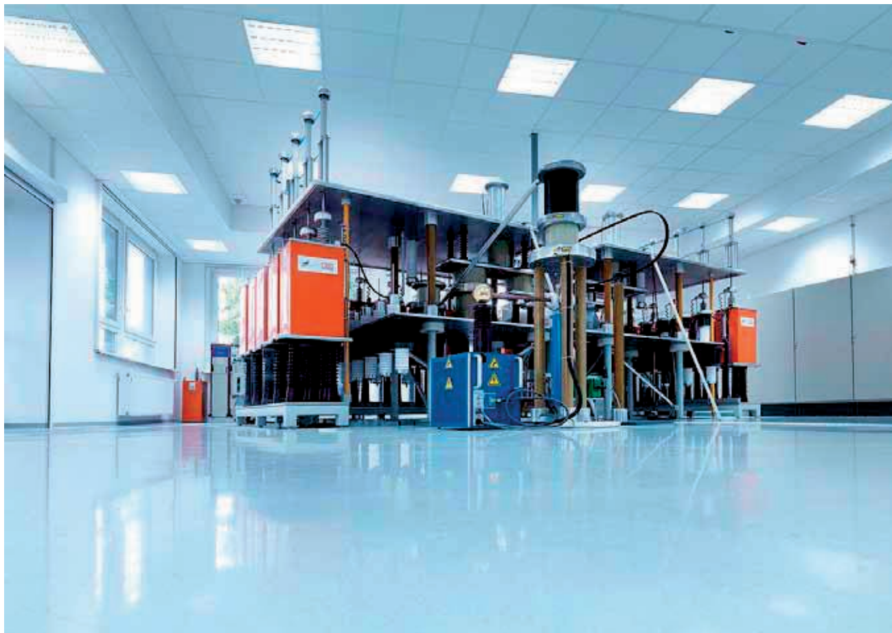
Generator struje groma
